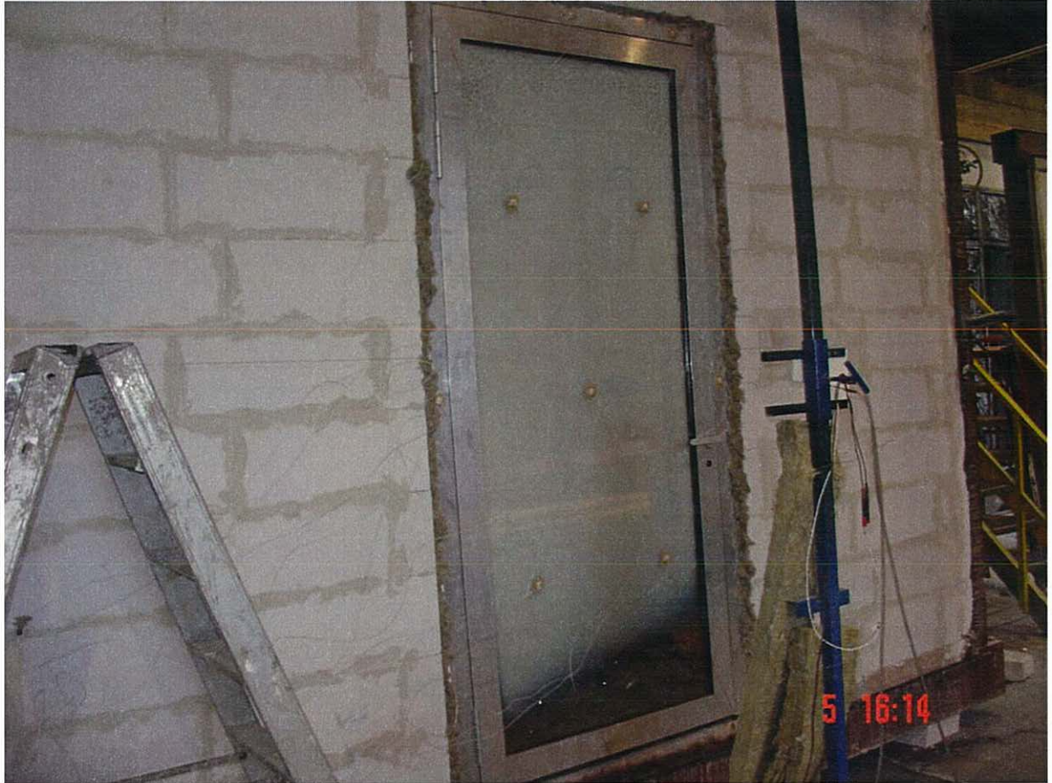
Foto 3 : aanzicht van de constructie na 3 minuten verhitting
