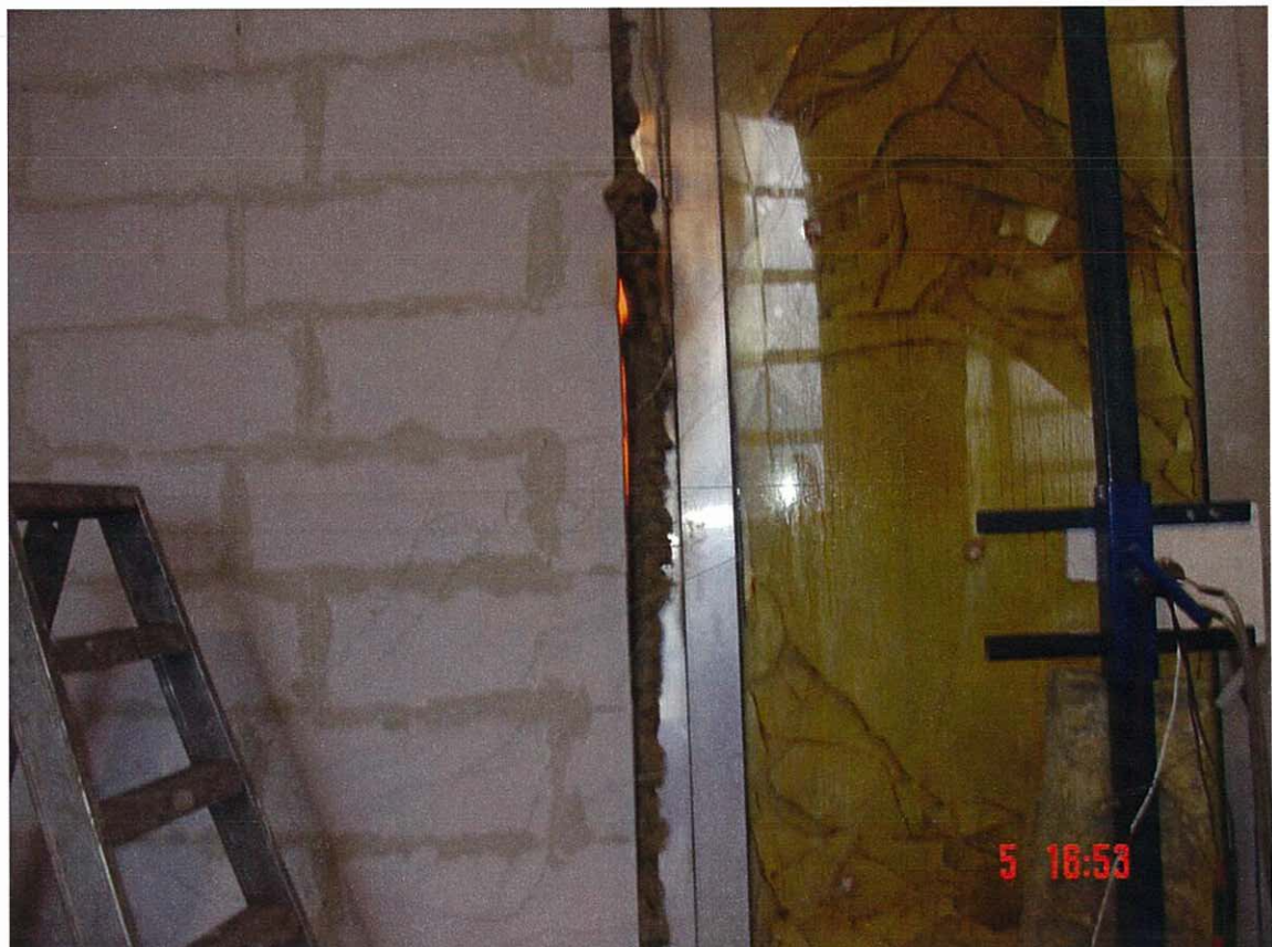
Foto 7 : aanzicht van de constructie na 42 minuten verhitting
