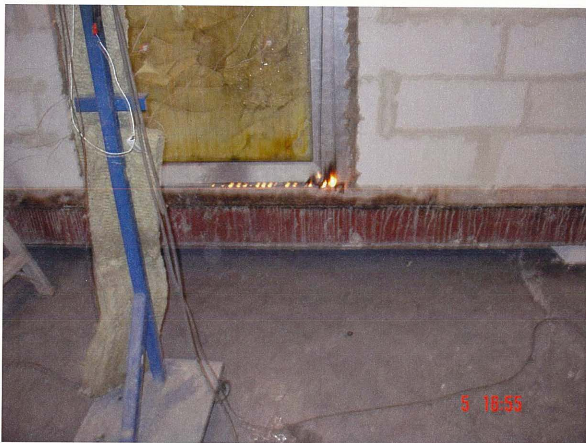
Foto 9 : detail van de constructie na 44 minuten verhitting. Dit is tevens eind van de verhitting.
