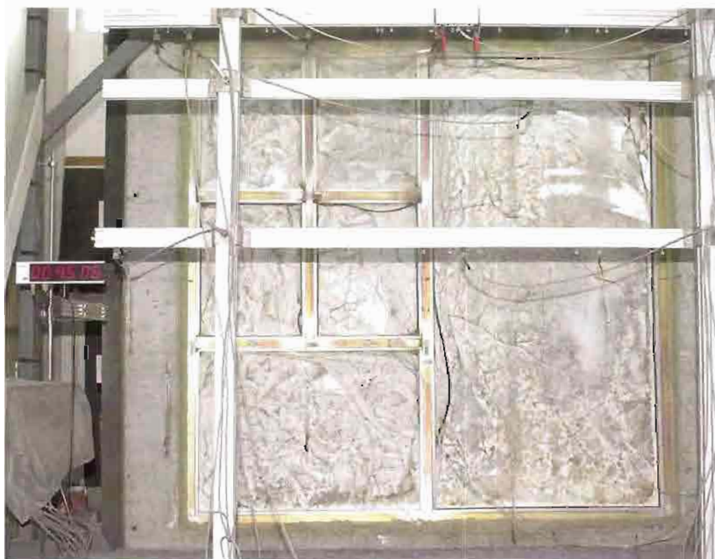
Foto 10 (BV 2 vom 19.4.2007, FS = Profillappenseite)) Ansicht der Kaltseite nach 45 Minuten Brandeinwirkung. Der Raumabschluss ist noch gewährleistet (Kriterium E noch erfüllt); die Oberflächentemperaturen auf der kalten Seite sind jedoch teilweise zu hoch (Kriterium I nicht mehr erfüllt).
