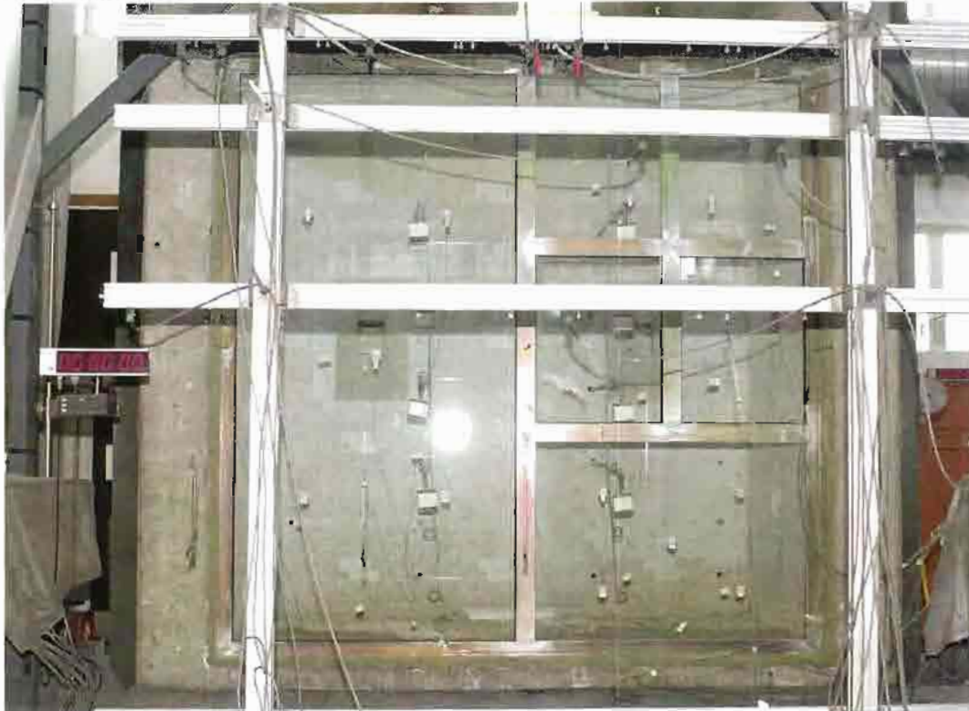
Foto 12 (BV 1 vom 20.4.2007, FS = Glashalteleiste) Ansicht der Kaltseite vor dem Start der Prüfung.
