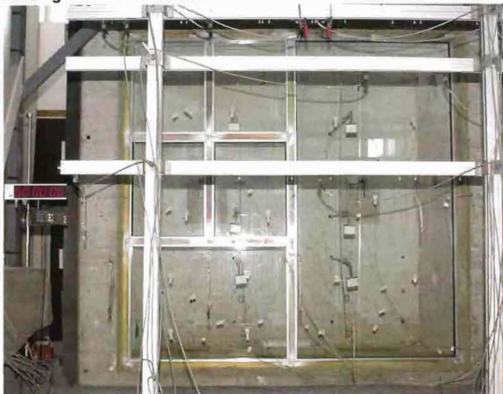
Foto 9 (BV 2 vom 19.4.2007, FS = Profillappenseite)) Ansicht der Kaltseite vor dem Start der Prüfung.
