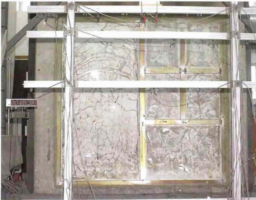
Foto 13 (BV 1 vom 20.4.2007, FS = Glashalteleiste) Ansicht der Kaltseite nach 45 Minuten Brandeinwirkung. Der Raumabschluss ist noch gewährleistet (Kriterium E noch erfüllt); die Oberflächentemperaturen auf der kalten Seite sind jedoch teilweise zu hoch (Kriterium I nicht mehr erfüllt).
